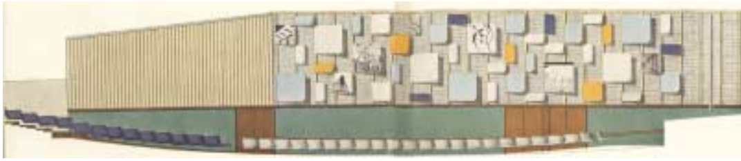
Arkitekttegning af sidevæggen i biografsalen med farvede plader og fotos der var sat af akustiske grunde. Foto: Arkitektur 1958.
